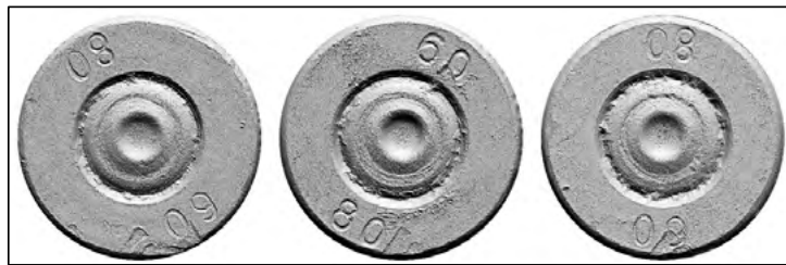
Ілюстрація № 8. Збільшене зображення слідів на гільзах патронів, стріляних з 5,45-мм автомата АК-12
