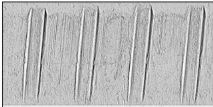
Ілюстрація № 11. Фоторозгортка слідів полів нарізів на кулях, стріляних з автоматів АК-12 (зверху) та АК-74 (знизу)
