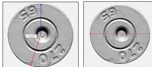
Ілюстрація № 9. Збільшене зображення слідів на гільзах патронів, стріляних з 5,45-мм автомата АК-74
