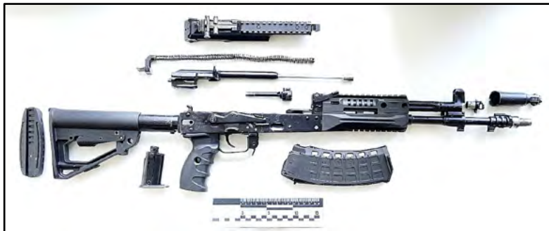
Ілюстрація № 1. 5,45-мм автомат Калашникова АК-12 та його основні частини
