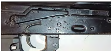
Ілюстрація № 2. Зображення перемикача вогню на ствольній коробці 5,45-мм автомата Калашникова АК-12
